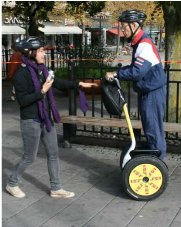
Professor Chen Shizhong får en kort instruktion: Luta dig lätt framåt så ökar farten, luta dig bakåt så bromsar du eller luta åt sidorna så svänger du. Intuitivt och enkelt. En Segway håller alltid balansen med avancerad datorstyrd gyroteknik.
